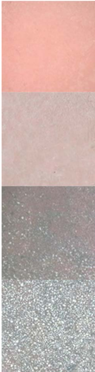
FIGURA 23. Destonificación por erosión superficial
