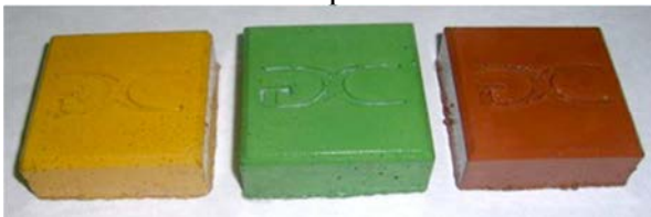
FIGURA 21. Sellado superficial con recubrimiento de resina
