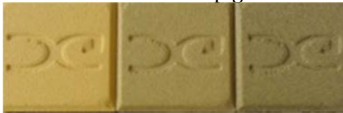
FIGURA 12. Probetas pigmentadas al 3% con amarillo ChromaFer 9520.
