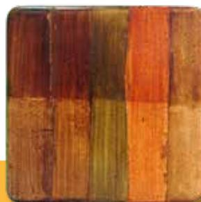
Ejemplo de recubrimientos imitación madera sobre una pieza de piedra artificial.
